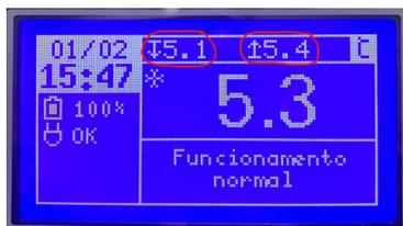
Fig.2. Indicações de temperatura máxima e mínima.
