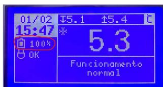
Fig.5 Capacidade da bateria de emergência.
